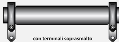
Le resistenze smaltate a filo trovano il loro impiego soprattutto nella funzione di frenatura dei motori elettrici e in quella di scarica dei condensatori.
