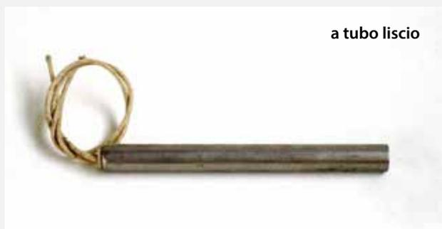
Le resistenze a cartuccia permettono di concentrare una potenza molto elevata in una superficie radiante ristretta; ciò consente di innalzare notevolmente la temperatura di blocchetti metallici in cui sia stato praticato un foro netto di alloggiamento (ad esempio, teste di estrusione o punzoni a caldo).
